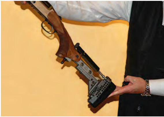
Die individuellen Schaftmaße werden mit einem sogenannten Gelenkschaft ermittelt.
