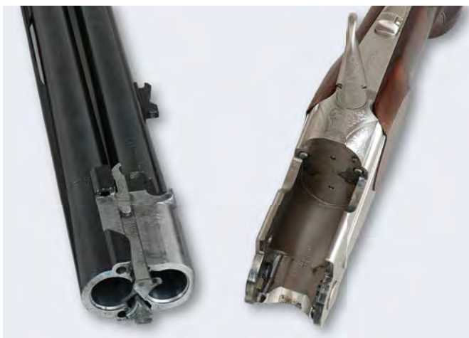
Flankenverschluss: Die Verriegelung in etwa Laufbündelmitte ist für die Kräfteaufnahme ideal. Der Verschluss erlaubt eine niedrige Bauweise.
