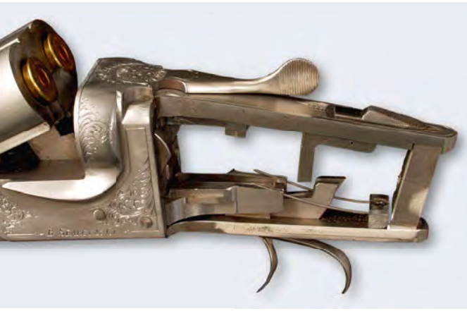
Blitzschloss, hier an einer Doppelbüchse: Alle Teile liegen auf dem Abzugsblech.
