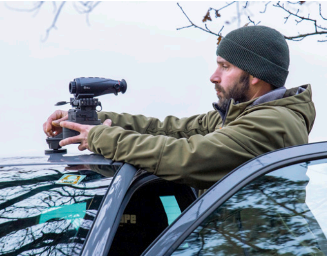
Das Beobachtungsgerät wird auf der Halterung montiert. Es lässt sich dann per Fernsteuerung drehen und kippen.
