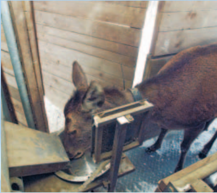
Eine automatische Fütterungsstation ermöglicht die genaue Erfassung der Nahrungsaufnahme und des Körpergewichtes.
