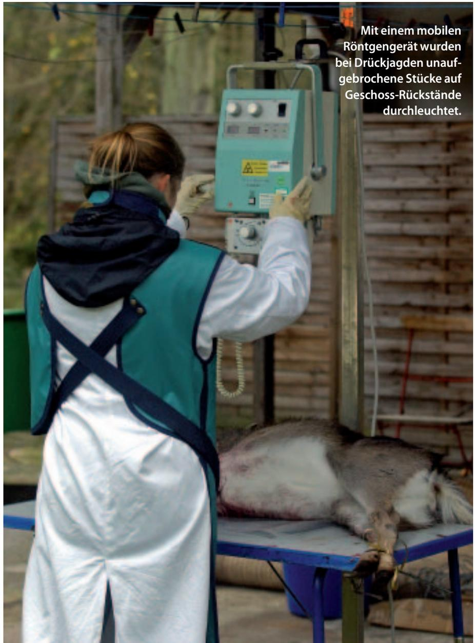
Mit einem mobilen Röntgengerät wurden bei Drückjagden unaufgebrochene Stücke auf Geschoss-Rückstände durchleuchtet.
