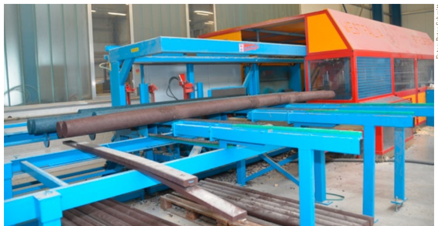
Rundpalisaden und Vierkantprofile werden ebenso automatisch hergestellt. Aus ihnen werden später das Anstanz-Gerüst und die Leitersprossen.
