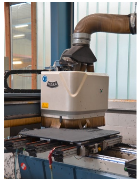
Die am Computer erstellten Muster werden aus Platten ausgefräst. So entstehen Sitzbrett und Rückenlehne.
