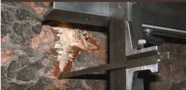
Nach einem Schussversuch: Treffererfassung an einem beschossenen Baumstamm
