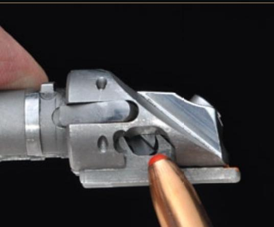
Die große Anlagefläche bei der Nase bedeutet maximale Sicherheit.
