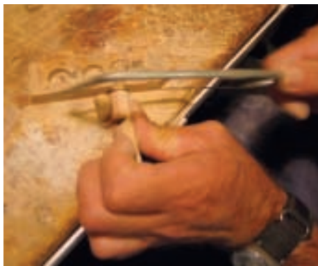
Anschließend wird das überstehende Ende vom Mundstück abgesägt und noch einmal sauber abgeschliffen
