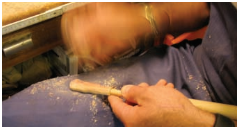
Per Hand wird die Flieder-Pfeife mit grobem Schmiergelpapier nachgebessert
