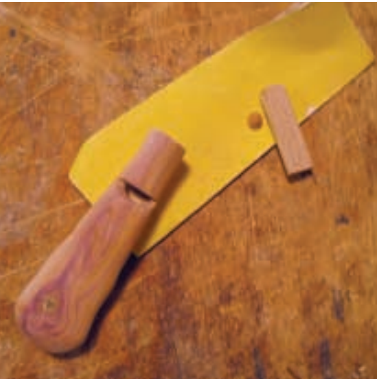
Korkkugel hinein, Mundstück auf dem Pfeifenende verleimen und trocknen lassen
