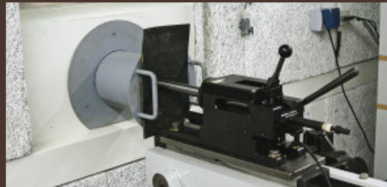
Von solch einem Schießbock wurden über 2 500 Schüsse maschinell abgegeben.
