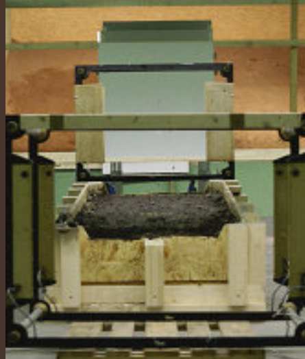
Das Abprallverhalten auf weichem Boden untersuchte die DEVA mit diesem Gestell.
