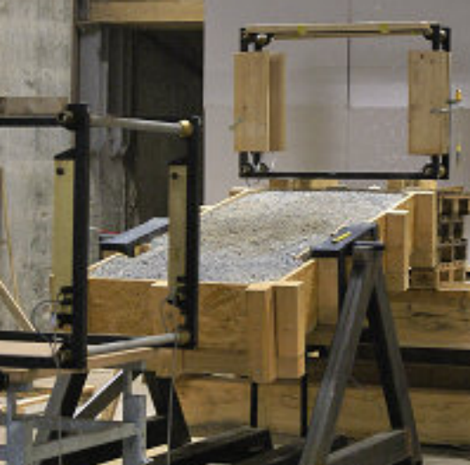
So sah der Versuchsaufbau für das Beschießen von hartem Boden aus.
