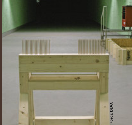
Mit dieser Konstruktion wurde der Schuss in ein Gebüsch simuliert.
